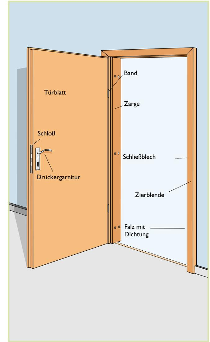
Holz-Türzargen sind je nach Fabrikat um einige Millimeter an der Zierblende verschiebbar. Dadurch können Mauerun-ebenheiten ausgeglichen werden. Beispiel: Gemessen wird eine Wandstärke von 18,5 cm inkl. Putz. Sie benötigen hierfür eine 18er Zarge.
