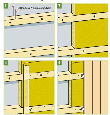
Holz hat von Natur aus schon sehr gute Dämmeigenschaften. Sie können damit den ständig steigenden Energiekosten entgegenwirken. Wird eine Holzbekleidung im Innenbereich angebracht, ist oftmals eine zusätzliche Wärmedämmung empfehlenswert. Insbesondere bei Renovierungsvorhaben in Altbauten bietet sich eine nachträgliche Isolierung an.
